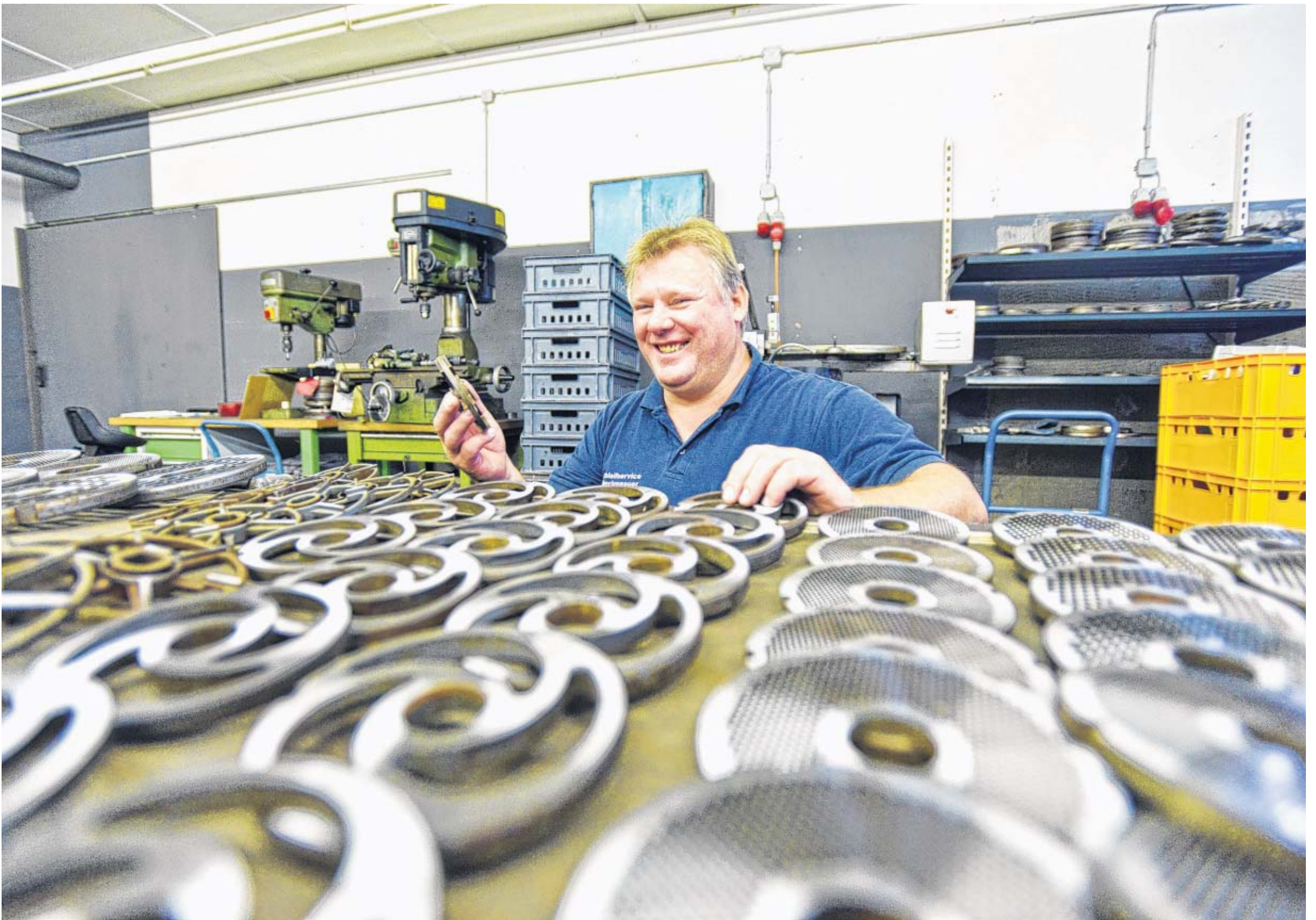
Für den Fleischwolf: Diese Messer, sogenannte Wolfssätze, sind zwischen 70 und 400 Millimeter groß. Über 100 verschiedene Ausführungen gibt es davon für die Industrie. Hans-Peter Oberluggauer zeigt sie.
