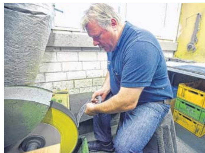
Für eine perfekte Klinge: Die Messer werden von Hand entgratet. So wird garantiert, dass der Schnitt wunderbar sauber ist.
